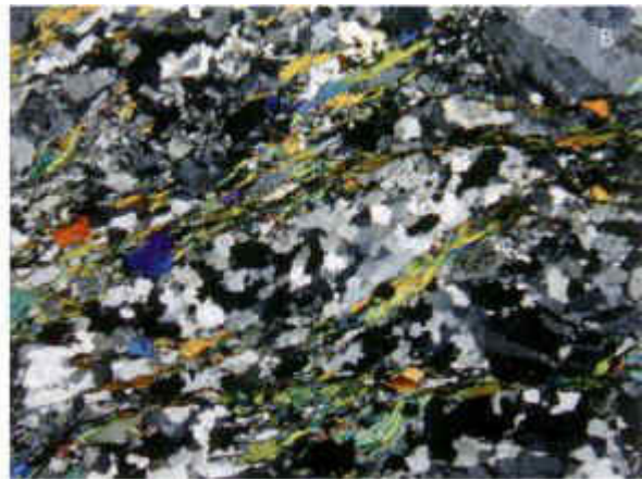
Olvadékból a feszültség minden irányban azonos, ezért az ásványok rendezetlenül helyezkednek el (gránit). Szilárd állapotú átalakulásnál orientáció alakul ki (gneisz). A két kőzet ásványos összetétele hasonló. Képszélesség: 8 mm
